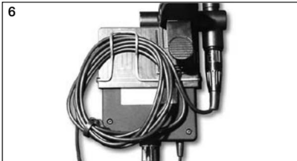
Abb. 4: Anschlusskabel aufrollen und fixieren
